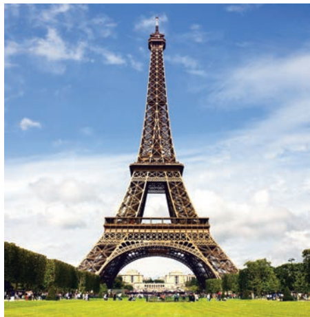
La torre Eiffel és un bon exemple de triangulació.
