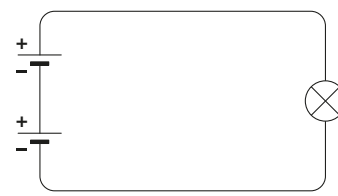
Bombeta alimentada per dues piles en sèrie.
